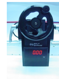
垂直方向に位置する2個のプーリーと抑えプーリーでシャフト軸を確実にホールドします。
