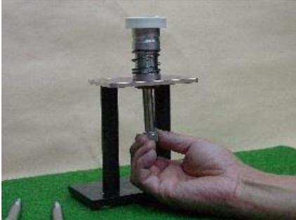
ウッドヘッドのフェース面・ソール面、アイアンヘッドのフェース面上での 重心位置が検索でき 極細マーカーパーン先で マーキングできます
