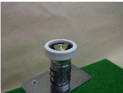
本器具の基板には マグネットを採用していますので装着、離脱は 水平な基板があれば簡単にセットでき使用できます
