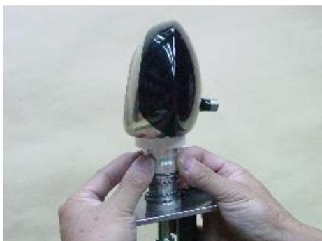
⑦ソール面で探す場合 検索ボルトの先端が 先ず 灰色 次に緑、次に黄色、の順に先端の小さい検索ボルトに交換し より小さい箇所を検索して下さい
